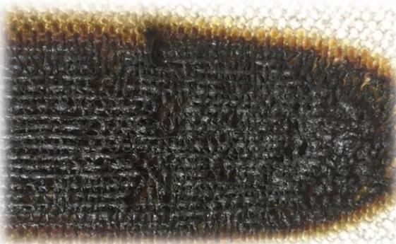
Unsere Faserimprägnierung schützt das Material indem eine intumeszierende Lösung in die Fasern eingearbeitet wird. Diese schäumt bei Feuerwirkung auf und bildet einen wirkungsvollen Brandschutz. Die beiden Bilder zeigen den Effekt nach 10 Minuten Einwirkung einer 1100°C heißen Flamme (Schweissbrenner) im 45° Winkel direkt auf die Oberfläche. Die Faserstruktur ist noch vollkommen intakt, da der gebildete Schaum diese optimal vor Feuer schützt.
